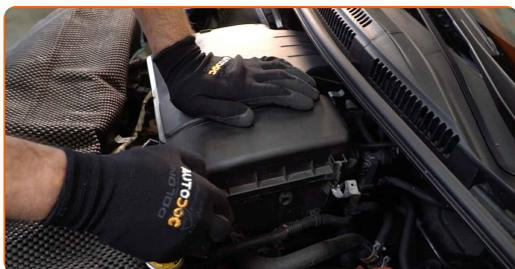
**15** Nainštalujte upevňovacie svorky rúrky odvzdušňovača vzduchového filtra a prívodnej rúrky vzduchového filtra. Použite kliešte na hadičky s držiakom.
