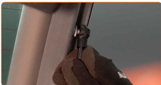
**9** Zacvaknite sponu spájajúcu plynovú vzperu ku karosérii auta.
