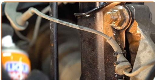
**52** Utiahnite vrchné upevnenie uloženia vzpery tlmiča. Použite nástavec č.13. Použite momentový klíč. Utiahnite ju krútiacim momentom 25 Nm.
