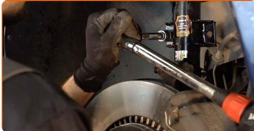
**50** Pripojte upevňovací prvak ABS snímača a jeho kábla k vzpere tlmiča.
