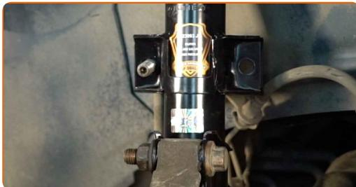
**49** Utiahnite upevnenie spájajúce vzperu stabilizátora k vzpere tlmiča. Použite nástavec č.18. Použite momentový klíč. Utiahnite ju krútiacim momentom 50 Nm.
