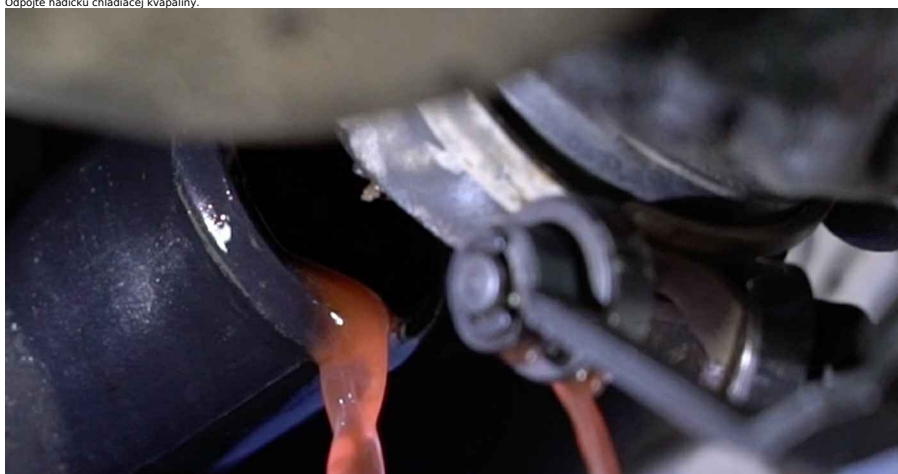
8 Odpojte hadičku chladiacej kvapaliny.
