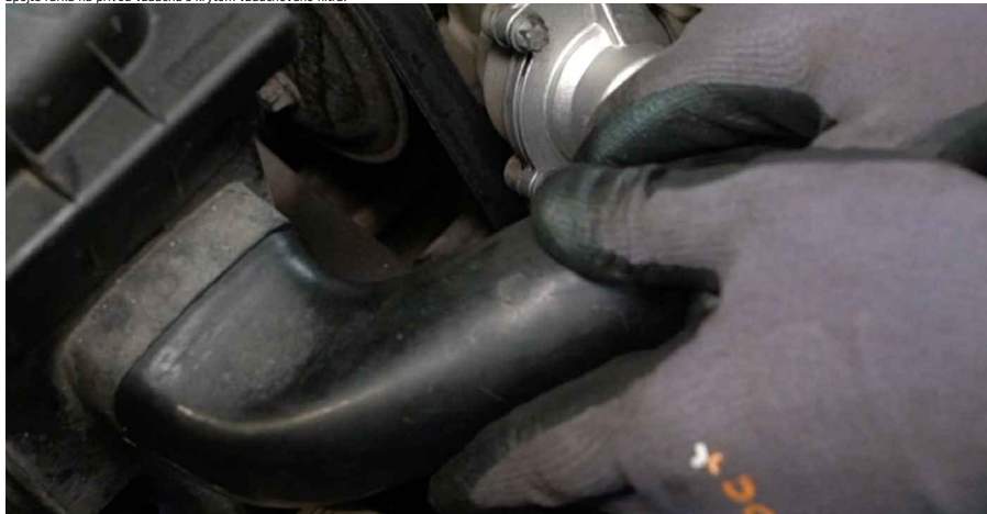
32 Pripevnite sponu na nasávaciu hadičku vzduchového filtra.
