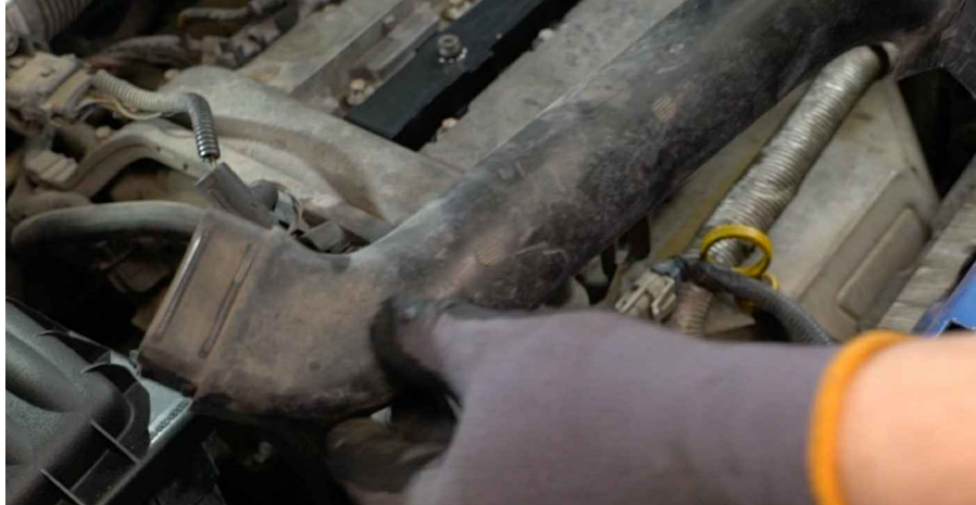
15 Vyčistite spojenia hadičiek chladiacej kvapaliny. Použite viacúčelový čistiaci sprej.
