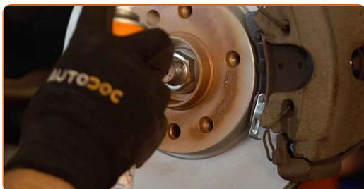
**43** Vyčistite povrch brzdového kotúča. Použite čistič brzd.
