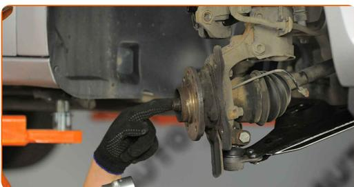
**19** Vyčistite upevnenie spájajúce čap tiahla riadenia k hlave ložiska čapu kolesa. Použite drôtenú kefu. Použite sprej WD-40.
