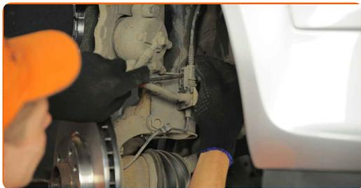
**11** Odpojte konektor ABS snímača.
