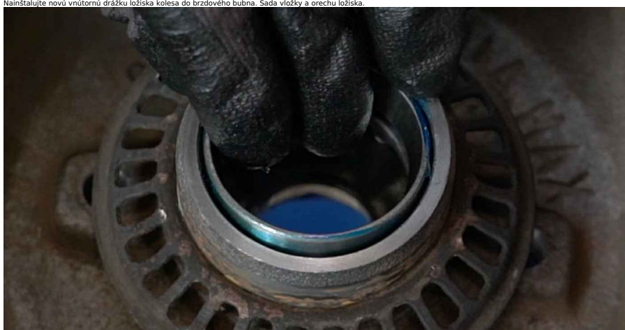
20 Natrite ložisko náboja kolesa. Použite mazivo na ložiská.
