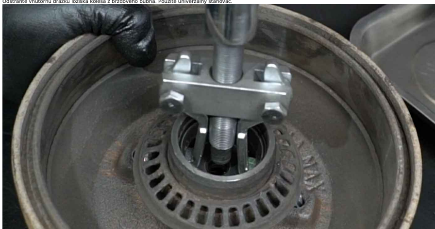
15 Odstráňte vnútornú drážku ložiska kola z brzdového bubna. Použite univerzálny sťahovač.
