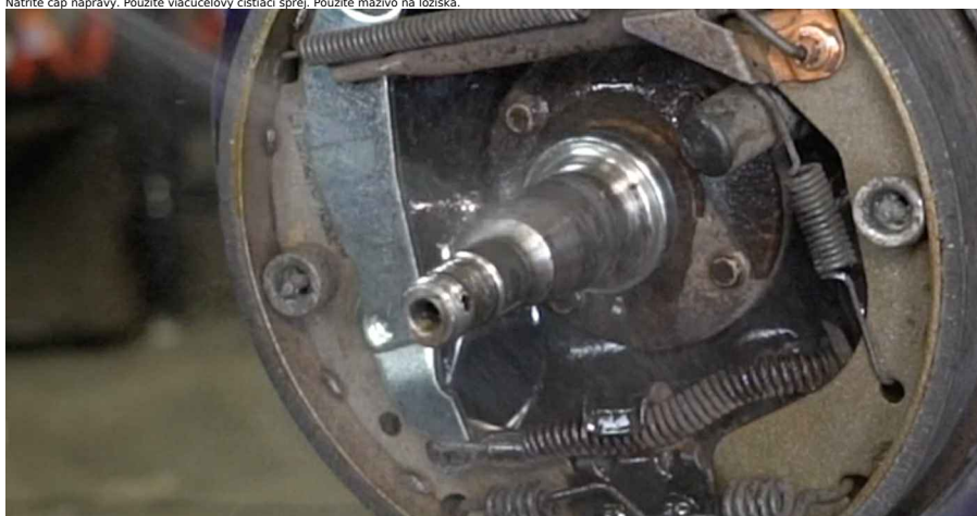
24 Nainštalujte brzdový bubon v zostave s ložiskom náboja kola.
