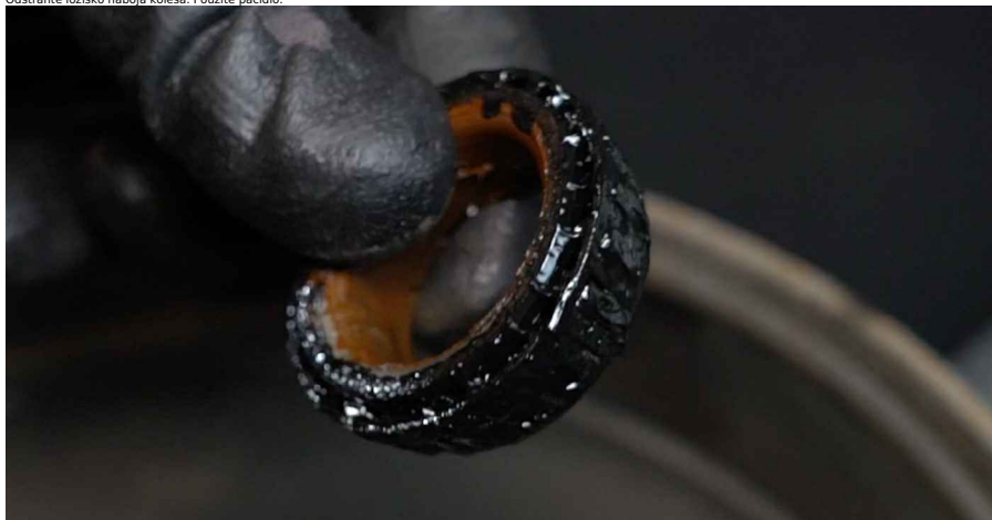
14 Vyčistíte montážny otvor ložiska náboja.
