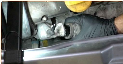
Výmena: termostatu – VAUXHALL Corsa Mk II (C) Hatchback (X01). AUTODOC odporúča:
