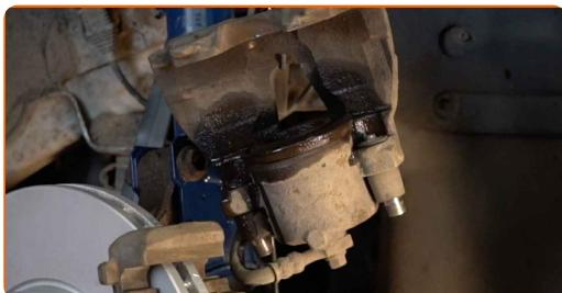
Výmena: brzdových platničiek – VAUXHALL Corsa Mk III (D) Hatchback (S07).
