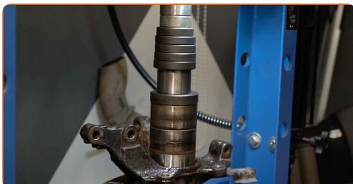
Výmena: ložiska kolesa – VAUXHALL Corsa Mk III (D) Hatchback (S07).
