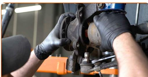
Výmena: ložiska kolesa – VAUXHALL Corsa Mk III (D) Hatchback (S07). Tip:
