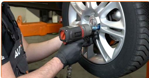
Výmena: brzdových kotúčov – VAUXHALL Corsa Mk IV (E) Hatchback (X15).
