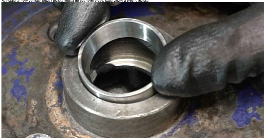
19 Nainštalujete novú vnútornú drážku ložiska kolesa do brzdového bubna. Sada vložky a orechu ložiska.
