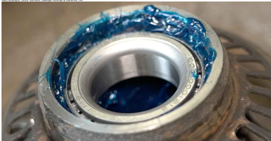
22 Nainštalujte olejové tesnenie ložiska kola.
