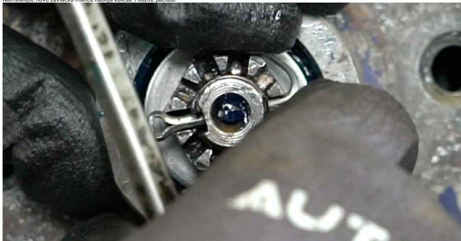
34 Nainštalujte uzáver skrutky náboja. Použite gumové kladivo.
