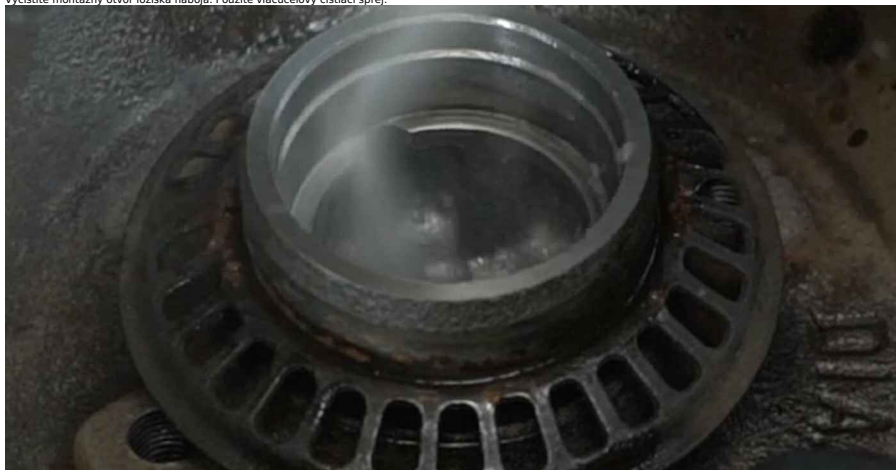
18 Nainštalujete nový vonkajší krúžok ložiska kolesa do bubnovej brzdy. Sada vložky a orechu ložiska.
