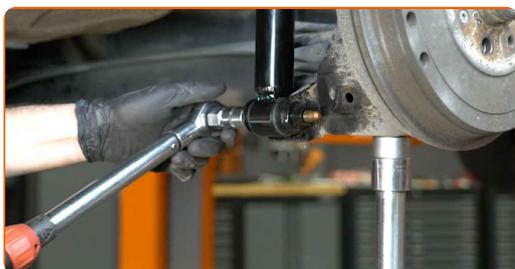
**36** Odstráňte upevnenie spod nosníka zadnej nápravy.
