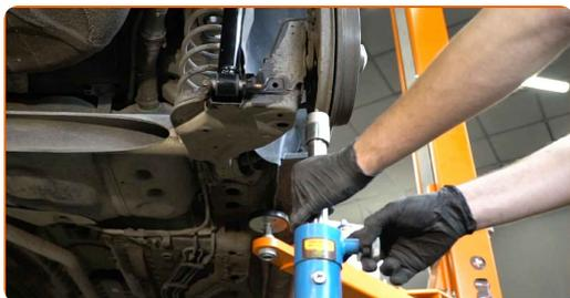
Výmena: tlmičov pruženia – VAUXHALL Corsavan Mk III (D) (S07). Tip:
