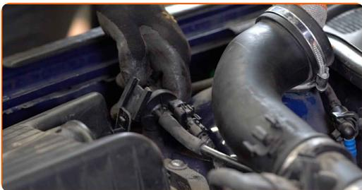
**8** Odstráňte veko filtra. Odstráňte filtračný prvok z krytu filtra.
