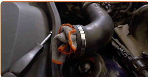
**7** Odpojte upevnenia spájajúce vzduchové potrubie a káblový zväzok ku krytu vzduchového filtra.
