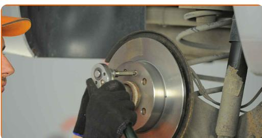
**17** Vyčistite montážne otvory brzdového strmeňa a jeho držiaka. Použite drôtenú kefu. Použite sprej WD-40.
