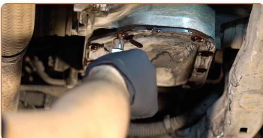
**10** Odstráňte vaňu prevodovej kvapaliny.
