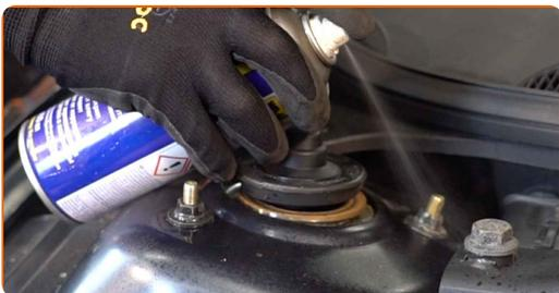
**4** Uvoľnite vrchný upevňovací prvok ložiska vzpery tlmiča. Použite nástavec č.13. Použite ráčňový kľúč.
