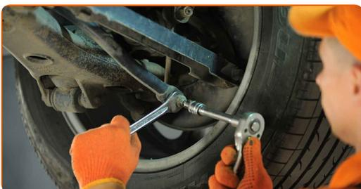
**4** Odskrutkujte upevňovací prvok spájajúci vzperu stabilizátora k ramenu zavesenia kolies. Použite kombinačný kľúč č.18 Použite hviezdicový Torx T40. Použite ráčňový kľúč.
