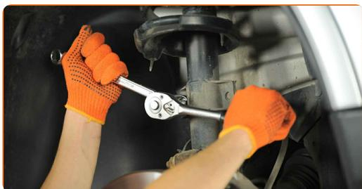
**14** Namažte všetky spojenia vzpery stabilizátora. Použite medené mazivo.
