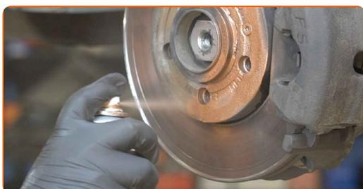
**16** Vyčistite povrch brzdového kotúča. Použite čistič brzd.
