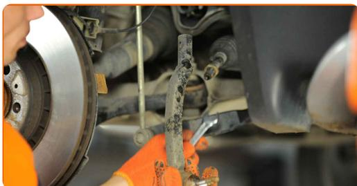
**13** Vyčistite montážne pozície čapu tiahla riadenia. Použite drôtenú kefu. Použite sprej WD-40.
