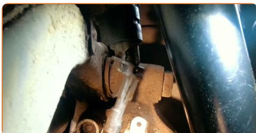
9 Odpojte konektor ABS snímača.
