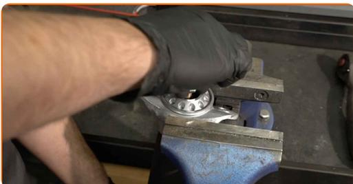
**19** Uťahnite maticu tyče tlmiča. Použite nástavec č.16. Použite rozperný nástavec na demontáž tlmičov DDN<sup>®</sup>6. Použite momentový kľúč. Uťahnite ju krútiacim momentom 25 Nm.
