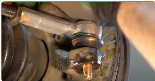
**16** Pri demontáži si zaznačte alebo odmerajte presnú polohu guľového čapu na spojovacej tyči, alebo spočítajte počet otočení, aby sa následne zabránilo zlému vyrovnaniu kolies. Použite posuvné meradlo.
