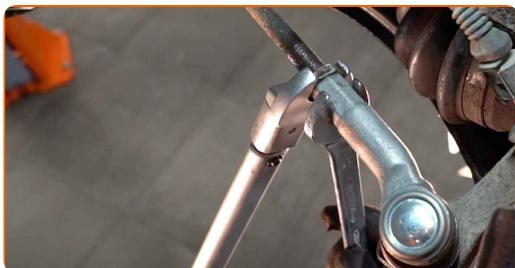
**18** Zaskrutkujte upevňovaciu maticu, ktorá spája čap tiahla riadenia k hlave ložiska čapu riadenia. Použite nástavec č.17. Použite ráčňový kľúč.
