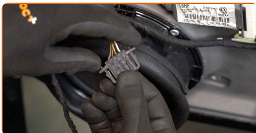
**15** Odpojte káblový zväzok elektrického okna. Použite nástroj na odstránenie spony.
