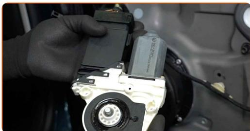
**18** Odpojte konektor elektrického okna.
