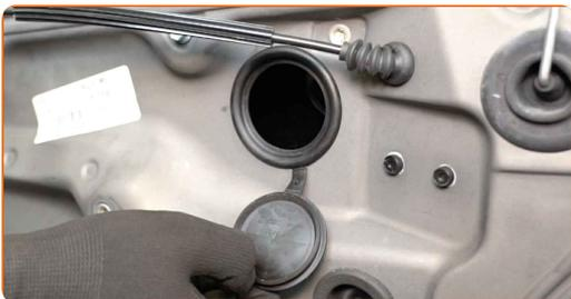
**10** Odsrutkujte upevňovacie prvky skla okna. Použite nástavec č.10. Použite ráčňový kľúč.
