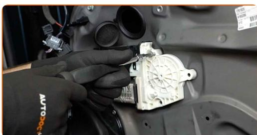
**17** Odstráňte elektromotor elektrického okna.
