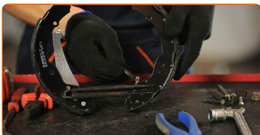
**17** Vyčistite montážne pozície brzdových čelústí. Použite drôtenú kefu.
