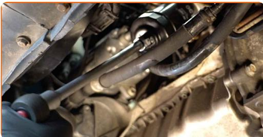
**14** Starý olejový filter vložte do nádoby.
