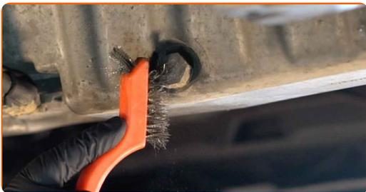
**9** Odskrutkujte výpust. Použite kombinačný kľúč č.19.
