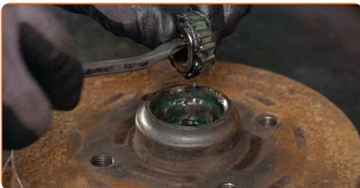
**15** Odstráňte vnútorné olejové tesnenie ložiska kola. Použite páčidlo.
