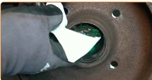
**18** Odstráňte vnútornú drážku ložiska kolesa z brzdového bubna. Použite 3-ramenný sťahovák ozubených koliesok. Použite sadu vložky a orechu ložiska.
