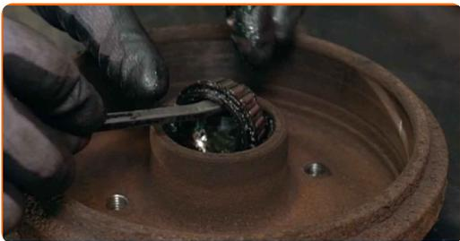
**17** Vyčistite montážny otvor ložiska náboja.
