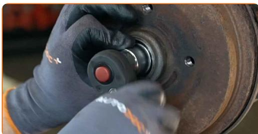
**12** Odstráňte brzdový bubon zostavený s ložiskom náboja kola.
