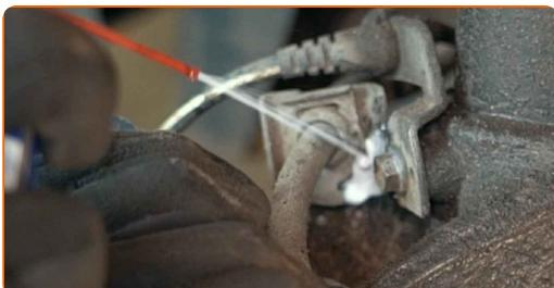
**17** Odskrutkujte upevňovaciu svorku brzdovej hadičky od vzpery tlmiča. Použite kombinačný klíč č.10.
