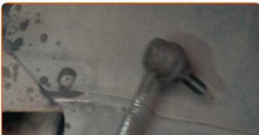
**16** Vyčistite upevňovacie prvky držiaka brzdovej hadičky. Použite drôtenú kefu. Použite sprej WD-40.
