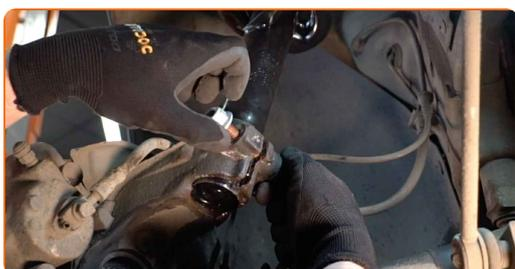
**54** Utiahnite spodné upevňovacie prvky spájajúce vzperu tlmiča k hlave ložiska čapu. Použite nástavec č.18. Použite XZN č. 12. Použite ráčňový kľúč.
