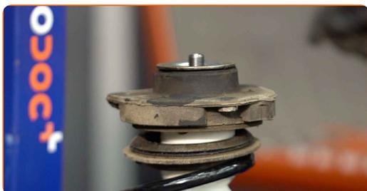
46 Upevnite maticu piestu vzpery tlmiča. Použite imbusový kľúč č. H6. Použite nástavec č.21. Použite momentový kľúč. Utiahnite ju krútiacim momentom 60 Nm.
