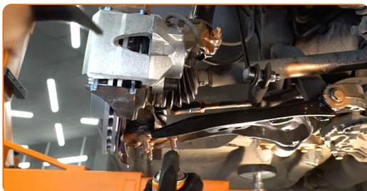
**66** Vyčistite povrch brzdového kotúča. Použite drôtenú kefu.
