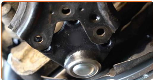
**17** Zaskrutkujte upevňovacie prvky guľového čapu. Použite nástavec č.13. Použite ráčňový kľúč.
