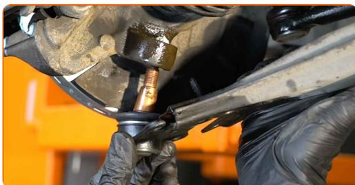
Výmena: guľového čapu – VW Fox Hatchback (5Z1, 5Z3, 5Z4). Tip od AUTODOC:
