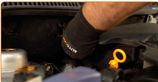
4 Odstráňte kryt motoru. Uloženie vzduchového filtra je integrované do krytu motora.
