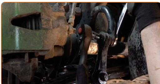
8 Odskrutkujte upevňovací prvak spájajúci stabilizátor s ovládacím ramenom. Použite nástavec č.16. Použite ráčňový kľúč.
