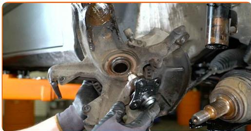
**35** Vyčistite upevňovacie prvky krytu brzdového kotúča. Použite drôtenú kefu. Použite sprej WD-40.
