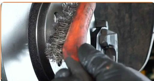
**87** Natrite povrch, kde je brzdový kotúč v kontakte s ráfikom kolesa. Použite keramické mazivo.
