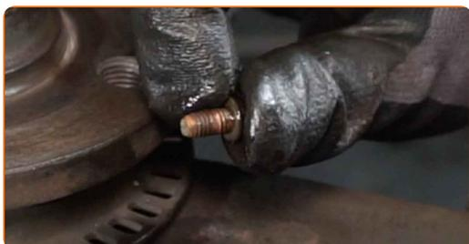
**38** Odstráňte kryt brzdového kotúča.
