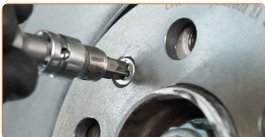
**75** Utiahnite upevňovacie prvky brzdového kotúča. Použite krížový skrutkovač PH. Použite momentový kľúč. Utiahnite ju krútiacim momentom 4 Nm.
