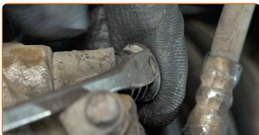
**11** Odskrutkujte upevňovacie prvky brzdového strmeňa. Použite imbusový kľúč č. H7. Použite ráčňový kľúč.
