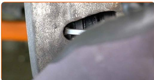
**10** Odstráňte krytky z protiprachových manžiet vodiacich kolíkov brzdového strmeňa. Použite páčidlo.
