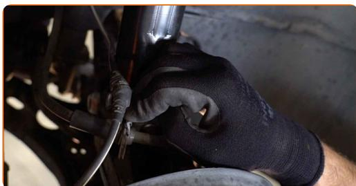
**52** Vyčistite montážny otvor disku kolesa. Použite drôtenú kefu. Natrite kontaktný povrch. Použite medené mazivo.
