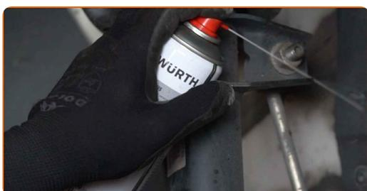
17 Odskrutkujte maticu a odstráňte tyčku stabilizátora zo vzpery tlmiča. Použite kombinačný kľúč č.16 Použite XZN č. 6. Použite ráčňový kľúč.
