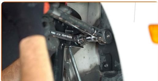
51 Pripojte upevňovací prvok ABS snímača a jeho kábla k vzpere tlmiča. Upevnite brzdovú hadičku na vzperu.
