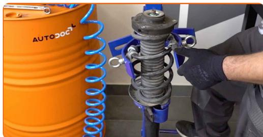
32 Vyčistite upevňovací prvok tyčky tlmiča. Použite drôtenú kefu. Použite sprej WD-40.
