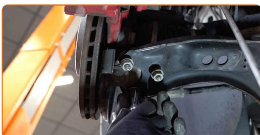
50 Zaistite stabilizačnú tyč na vzpere zavesenia kolies. Použite kombinačný kľúč č.16 Použite XZN č. 6. Použite momentový kľúč. Utiahnite ju krútiacim momentom 65 Nm.
