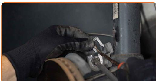
16 Vyčistite upevňovacie prvky spájajúce vzpery stabilizátora a vzperu tlmiča, a upevňovacie prvky spájajúce vzperu tlmiča a hlavu ložiska čapu. Použite drôtenú kefu. Použite sprej WD-40.
