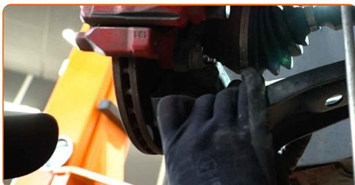
49 Utiahnite upevňovaciu maticu guľového čapu. Použite nástavec č.16. Použite momentový kľúč. Utiahnite ju krútiacim momentom 60 Nm.
