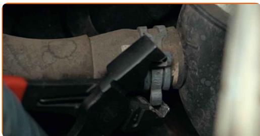
27 Odpojte hornú hadičku chladiacej kvapaliny.
