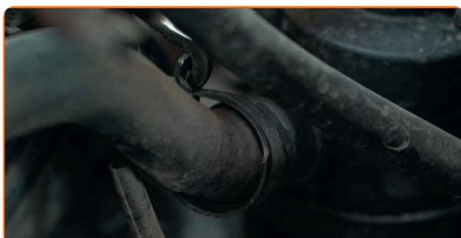
29 Odpojte hornú hadičku chladiacej kvapaliny.
