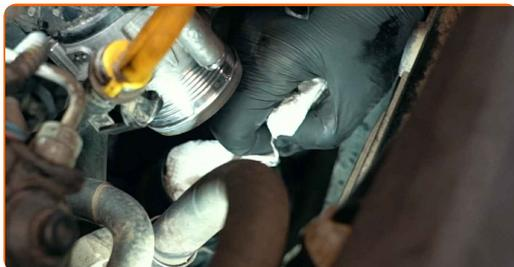
58 Vyčistite montážnu pozíciu prívodnej vzduchovej hadice. Použite viacúčelový čistiaci sprej.
