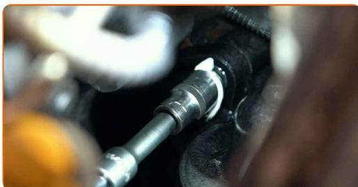
43 Utiahnite upevňovacie prvky krytu termostatu. Použite nástavec č.10. Použite momentový kľúč. Utiahnite ju krútiacim momentom 9 Nm.
