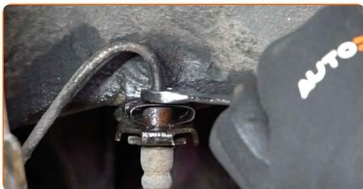
**14** Odskrutkujte brzdovú rúrku od brzdovej hadičky.
