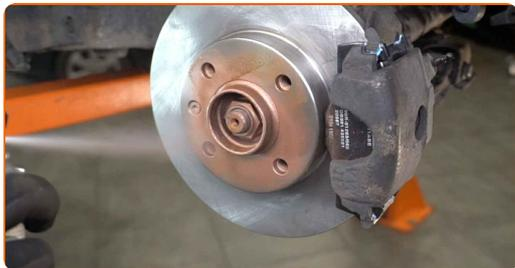
**32** Vyčistite povrch brzdového kotúča. Použite čistič brzd.
