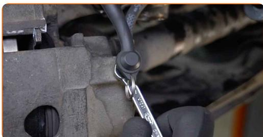
**28** Odpojte set na odvzdušnenie brzd.
