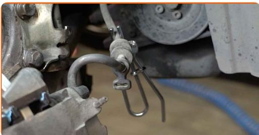
**10** Pod auto dajte nádobu na vypúšťanú brzdovú kvapalinu.
