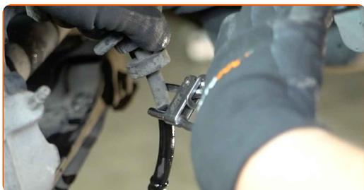
**16** Odskrutkujte prvky brzdovej hadičky od brzdového strmeňa.
