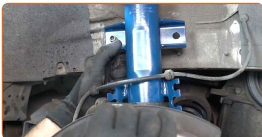
**71** Utiahnite upevnenie spájajúce vzperu stabilizátora k vzpere tlmiča. Použite nástavec č.18. Použite momentový kľúč. Utiahnite ju krútiacim momentom 60 Nm.+45°
