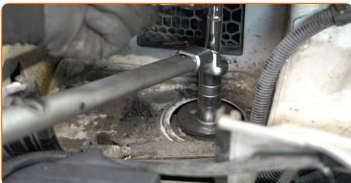
**84** Natrite vrchné upevnenie uloženia tlmiča. Použite medené mazivo.
