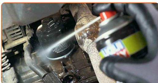
**11** Odskrutkujte olejový filter. Použite nástavec č.30. Použite ráčňový kľúč.
