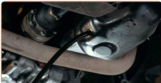
Výmena: oleje a filtru – VW New Beetle Cabrio (1Y7). AUTODOC odporúča:
