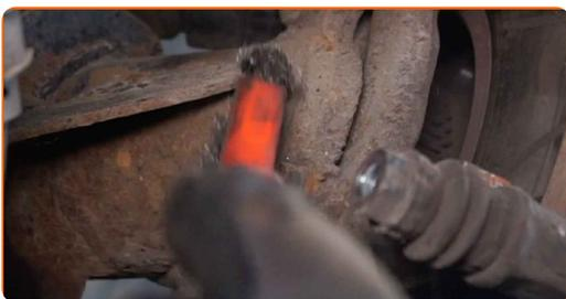
**14** Odskrutkujte upevňovacie prvky držiaka brzdového strmeňa. Použite imbusový kľúč č. H8. Použite ráčňový kľúč.
