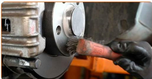
**48** Natrite povrch, kde je brzdový kotúč v kontakte s ráfikom kolesa. Použite keramické mazivo.
