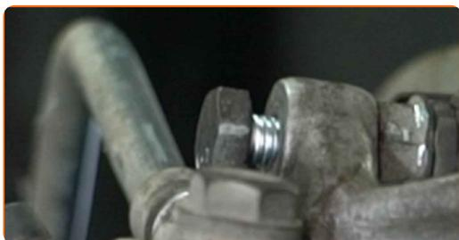
**46** Utiahnite upevňovacie prvky brzdového strmeňa. Použite nástavec č.13. Použite momentový kľúč. Utiahnite ju krútiacim momentom 35 Nm.
