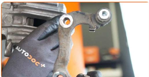
**17** Vyčistite upevnenie brzdového kotúča. Použite drôtenú kefu. Použite sprej WD-40.
