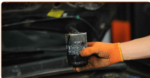
**14** Vyčistite miesto uloženia olejového filtra. Použite viacúčelový čistiaci sprej.
