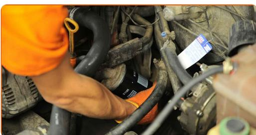
**17** Odstráňte uzáver olejového systému.
