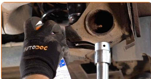
**24** Odstráňte upevnenie spod nosníka zadnej nápravy.
