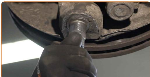
**80** Utiahnite upevnenie guľového čapu. Použite kombinačný kľúč č.18. Použite momentový kľúč. Utiahnite ju krútiacim momentom 110 Nm.
