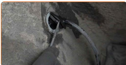
**25** Odpojte konektor ABS snímača.
