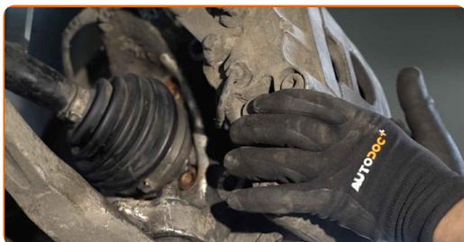
**78** Upevnite svorku brzdového strmeňa. Použite nástavec č.21. Použite momentový kľúč. Utiahnite ju krútiacim momentom 190 Nm.
