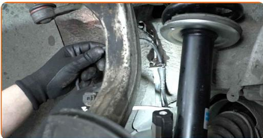
**73** Pripevnite konektor ABS snímača.
