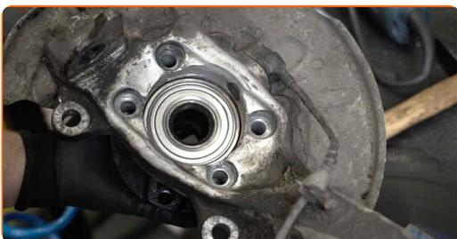
**50** Upevnite náboj. Použite XZN č. 12. Použite momentový kľúč. Utiahnite ju krútiacim momentom 80 Nm.+90°
