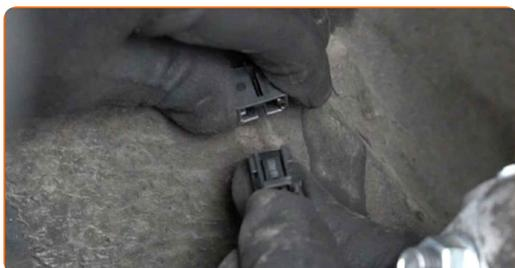
**26** Vyčistite všetky spojenia ramena. Použite drôtenú kefu. Použite sprej WD-40.
