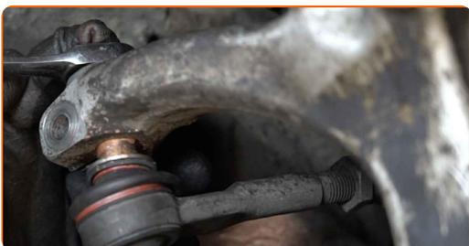
**64** Zaskrutkujte upevňovaciu maticu, ktorá spája čap tiahla riadenia k hlave ložiska čapu riadenia. Použite nástavec č.15. Použite ráčňový kľúč.
