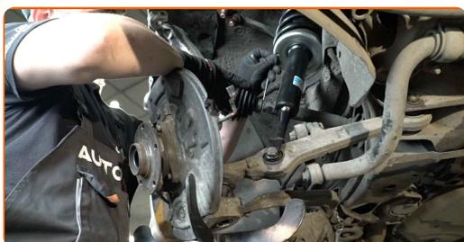
Výmena: ložiska kola – VW PASSAT (3B2). Tip od odborníkov z AUTODOC:
