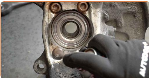
**52** Uvoľnite zverák a vytiahnite náboj kolesa spolu s ložiskom.
