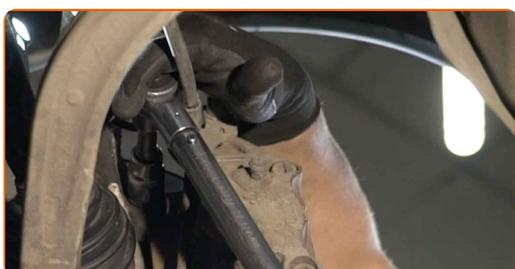
**79** Utiahnite upevnenie guľového čapu. Použite nástavec č.18. Použite momentový kľúč. Utiahnite ju krútiacim momentom 110 Nm.
