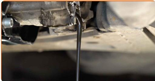
Výmena: olej do manuálnej prevodovky – VW Passat B5 Kombi (3B5).
