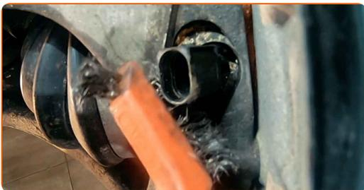
**8** Odskrutkujte upevnenie ABS snímača. Použite imbusový kľúč č. H5. Použite ráčňový kľúč.
