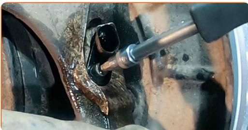
**9** Odpojte snímač ABS.
