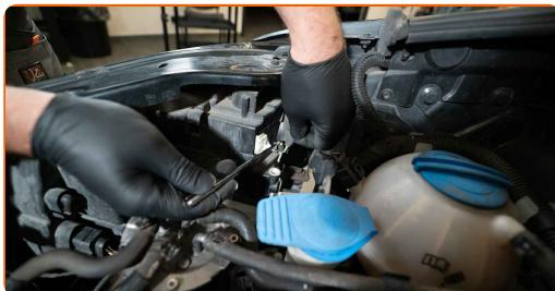
**3** Odpojte držiak žiarovky otočením o ~30°. Odstráňte držiak z montážneho miesta predného svetla.
