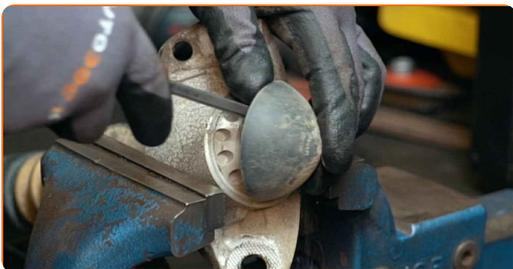
**21** Vyčistite upevňovací prvok tyčky tlmiča. Použite drôtenú kefu. Použite sprej WD-40.
