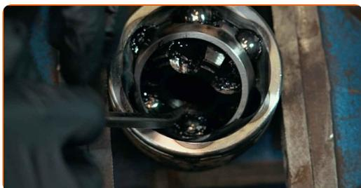
**29** Vyčistite montážnu pozíciu homokinetického kĺbu. Použite viacúčelový čistiaci sprej.
