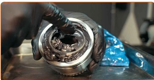
**35** Pohnite vnútornou drážkou homokinetického kĺbu zo strany na stranu, aby pevne zapadla.
