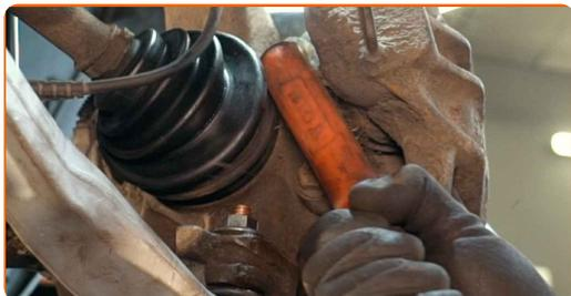
**9** Odskrutkujte upevnenie svorky brzdového strmeňa. Použite nástavec č.17. Použite ráčňový kľúč. Použite vratidlo.
