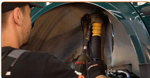
Výmena: tlmičov pruženia – VW PASSAT Variant (3B5). Tip od AUTODOC:
