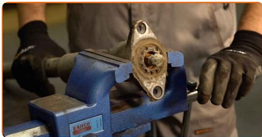
**15** Vyčistite upevňovací prvok tyčky tlmiča. Použite drôtenú kefu. Použite sprej WD-40.
