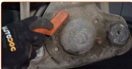
**27** Uvoľnite vrchný upevňovací prvok ložiska vzpery tlmiča. Použite nástavec č.13.
