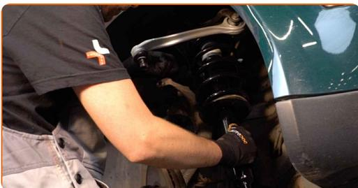
**47** Zaskrutkujte vrchné upevnenie uloženia vzpery tlmiča. Použite nástavec č.15. Použite ráčňový kľúč. Neuťahujte ho.
