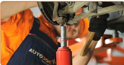
**37** Utiahnite upevňovaciu skrutku, ktorá spája vidlicu tlmiča odpruženia k spodnému ovládacímu ramenu. Použite kombinačný kľúč č.18. Použite nástavec č.18. Použite momentový kľúč. Utiahnite ju krútiacim momentom 90 Nm.
