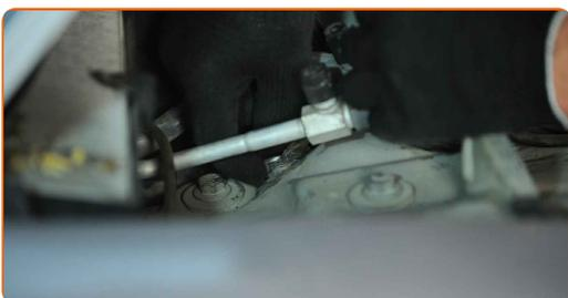
**15** Odskrutkujte upevňovacie prvky na vrchnej strane vzpery tmiča. Použite nástavec č.13. Použite ráčňový kľúč.
