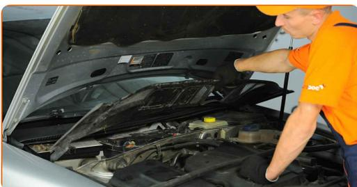
**14** Odstráňte kryt ložiska vzpery tmiča. Použite plochý skrutkovač.
