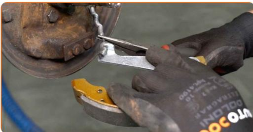
**21** Nainštalujte páku nastavovača brzdovej čeluste.
