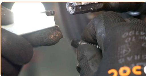
**19** Odstráňte páku nastavovača brzdovej čeluste.
