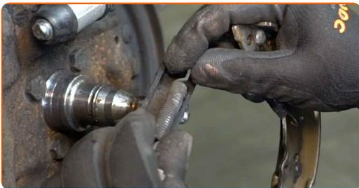
**18** Odpojte lanko ručnej brzdy. Použite páčidlo.
